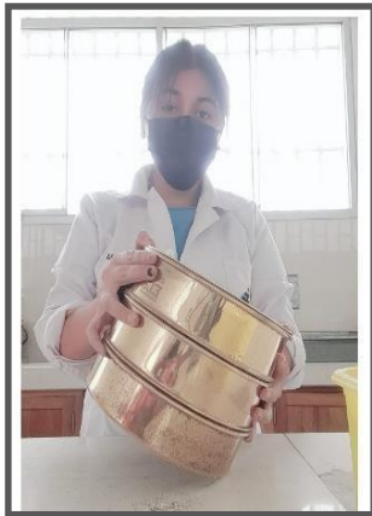
3) Tamizando las maruchas con el Tamiz N°200.
