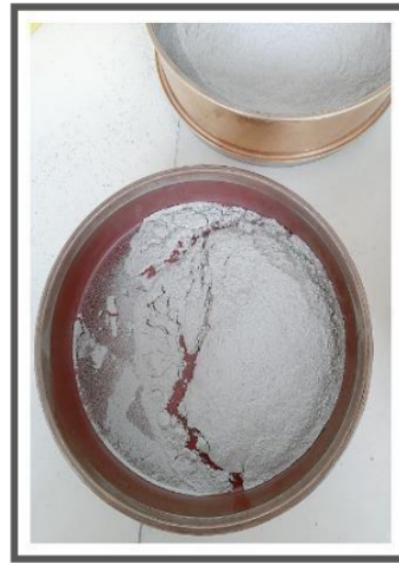
4) Utilizaremos para el proyecto los q paso por el Tamiz N° 200.
