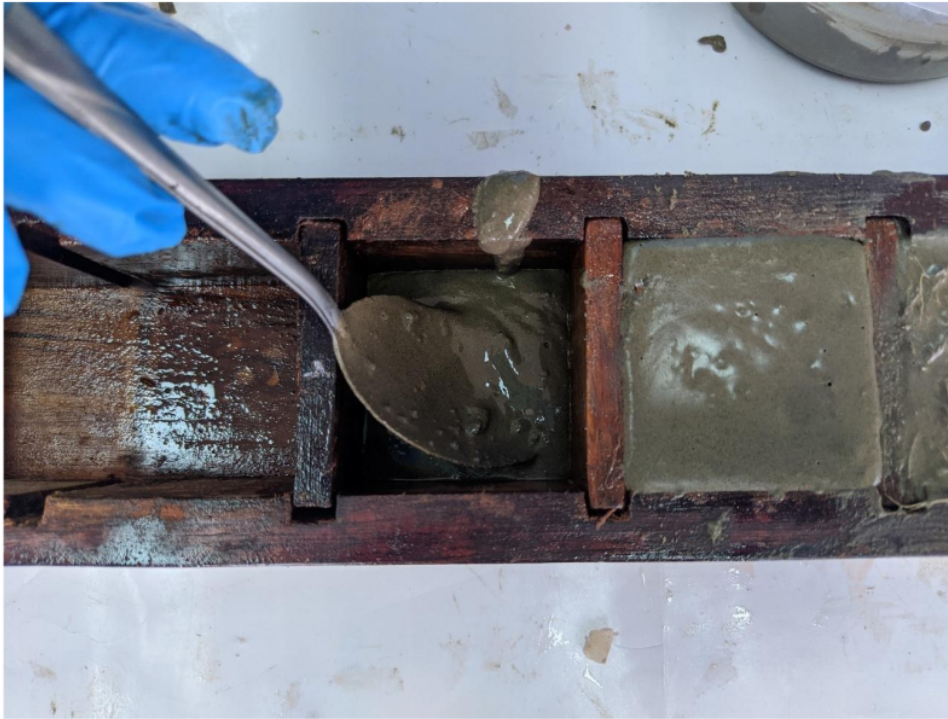
Vertimiento de morteros en molde
