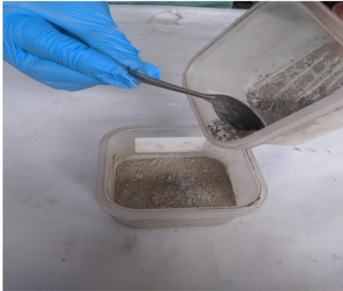
Adición de activador alcalino con solución de NaOH 8M
