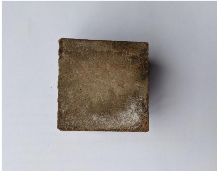
Vista inferior de mortero geopolimérico
