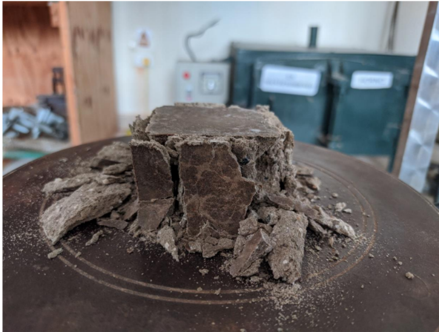
Porosidad de mortero geopolimérico con 0% de adición de polvo de vidrio
