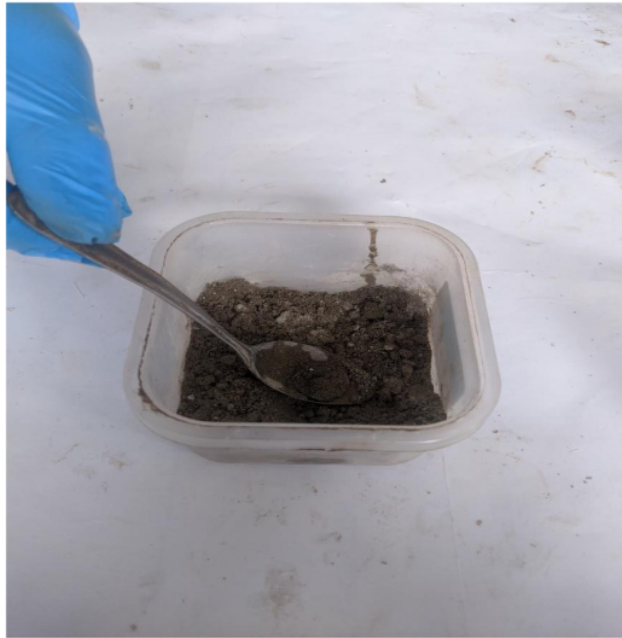
Acondicionamiento de las mezclas de mortero en su respectivo molde
