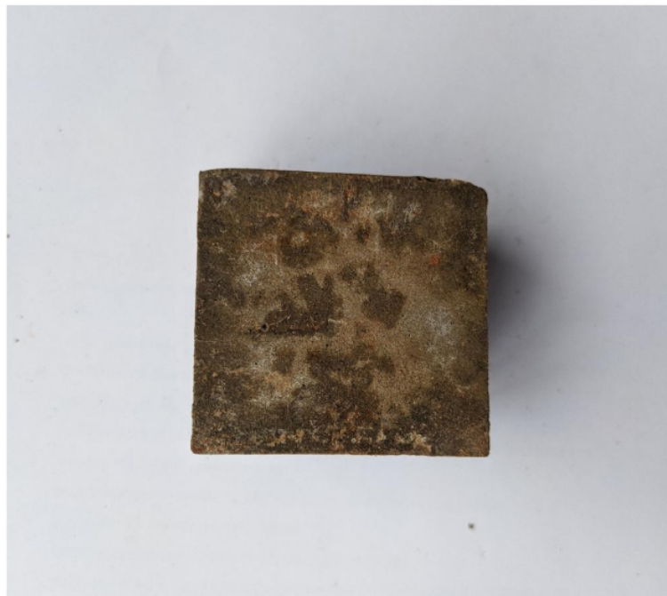
Vista inferior de mortero geopolimérico
