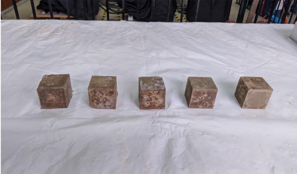
Morteros con 15% de adición de polvo de vidrio
