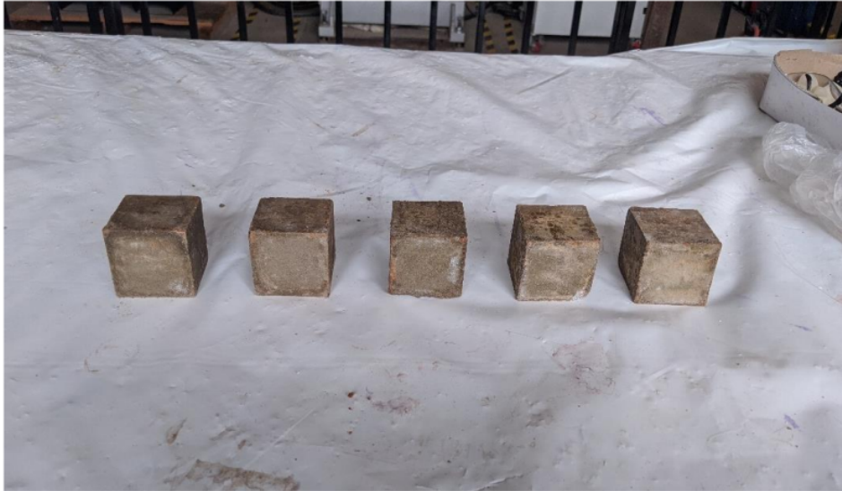
Morteros con 5% de adición de polvo de vidrio
