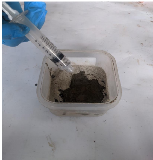
Adición de activador alcalino con solución de NaOH 8M
