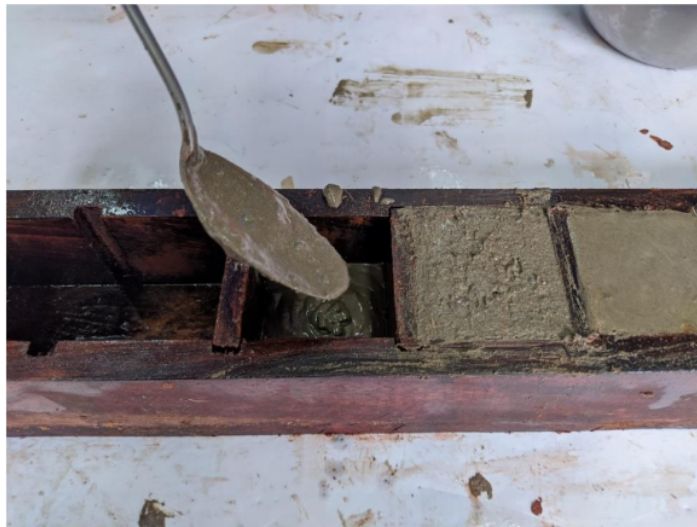
Acondicionamiento de las mezclas de mortero en su respectivo molde
