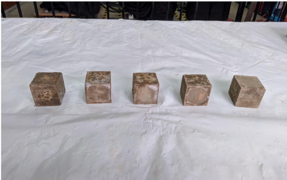
Morteros con 5% de adición de polvo de vidrio
