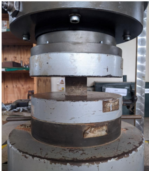
Mortero geopolimérico sometido a esfuerzo de compresión
