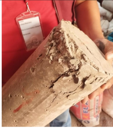
Briqueta rota a compresión
