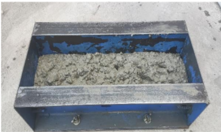
Elaboración de las vigas para 14 días
