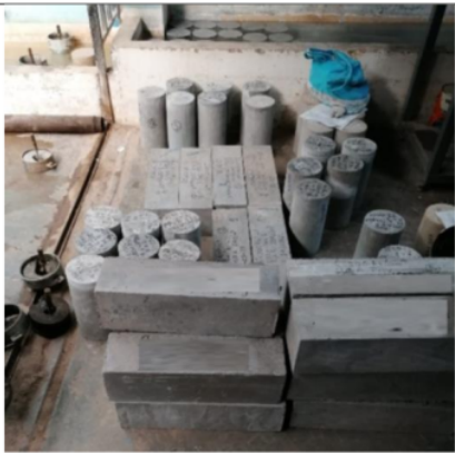
Vigas y briquetas listas para los ensayos de compresión y flexión
