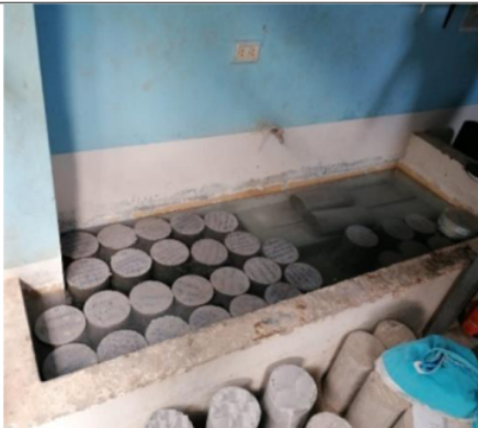
Fraguado de las muestras vigas y briquetas
