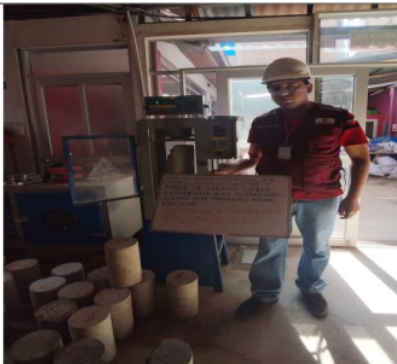
Ensayos a compresión a los 7 días
