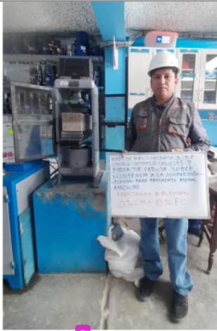
Ensayo de flexión a los 14 días
