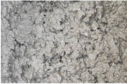
Concreto adicinado fibra de Cabuya y ceniza de Schinus
