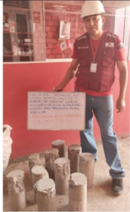
Muestras ya ensayadas a compresion en el laboratorio
