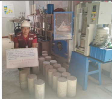
Ensayos a compresión a los 14 días
