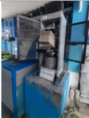
Ensayo de flexión a los 14 días
