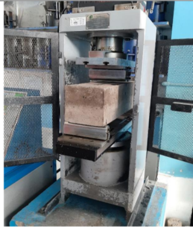
Ensayo a flexión
