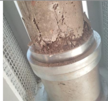
Ensayos a compresión a los 28 días
