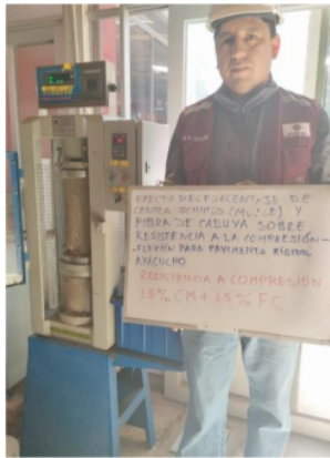
Ensayos a compresión a los 14 días
