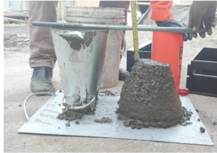
Prueba de asentamiento "SLUMP"
