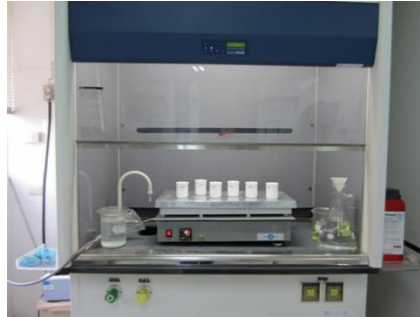
Calentando vasos en una plancha eléctrica y dentro de una campana
