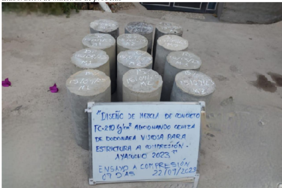
Figura 15 Elaboración de muestras de probetas
