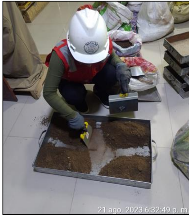
Fotografía N° 03. Se visualiza a la bachiller Yasmin Yshuly De La Cruz Sánchez, realizando el cuarteo de la muestra calicata 01. En el laboratorio de suelos.
