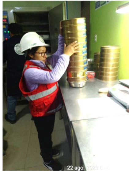
Fotografía N° 07. Se visualiza a la bachiller Yasmin Yshuly De La Cruz Sánchez, realizando el análisis granulométrico
