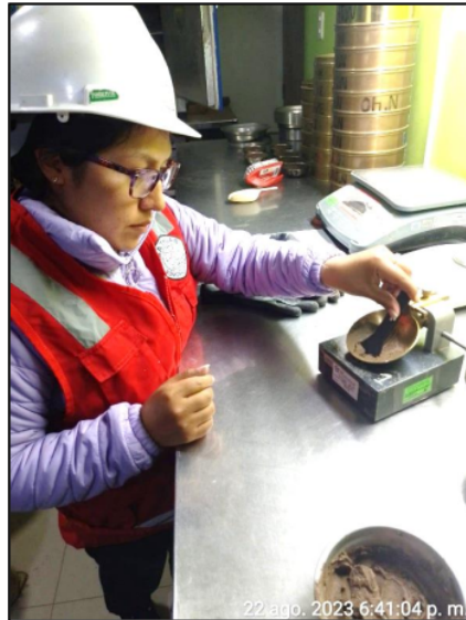
Fotografía N° 05. Se visualiza a la bachiller Yasmin Yshuly De La Cruz Sánchez, calculando el límite líquido de Atterberg con la cuchara de Casa Grande.
