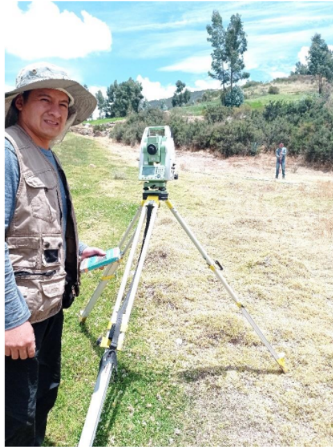
Fotografía 11. Levantamiento topográfico (línea de conducción)
