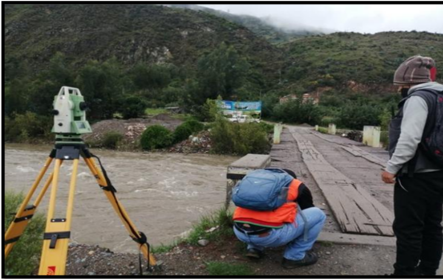
Realizando levantamiento topográfico del Puente Malpaso del Centro Poblado Chavín.
