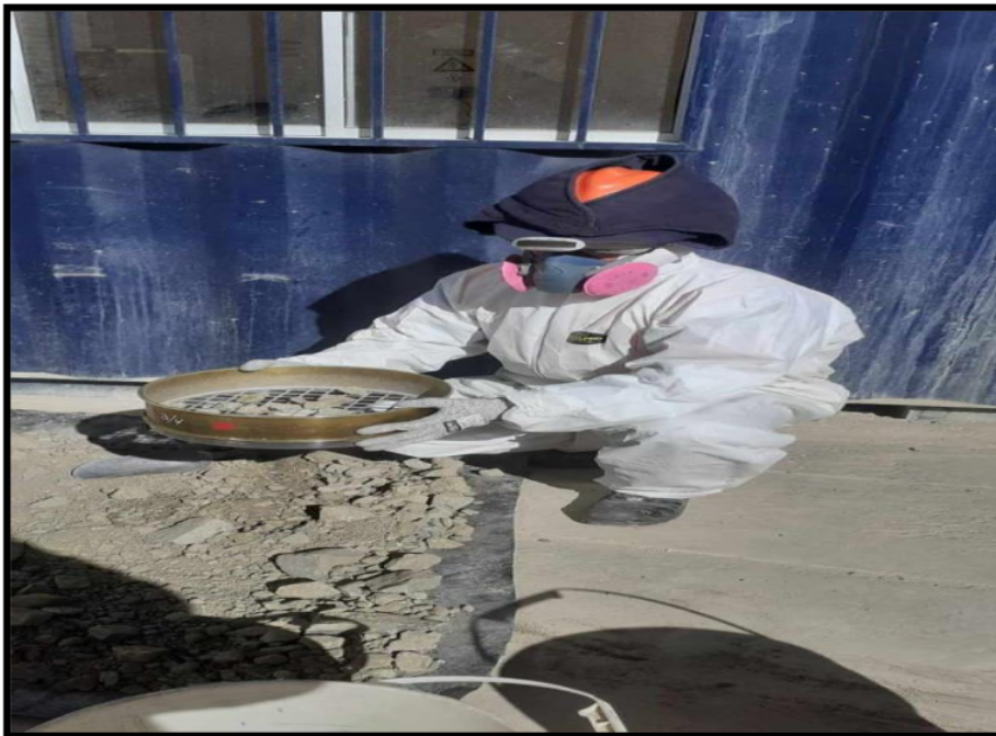
Realizando el estudio Granulométrico.
