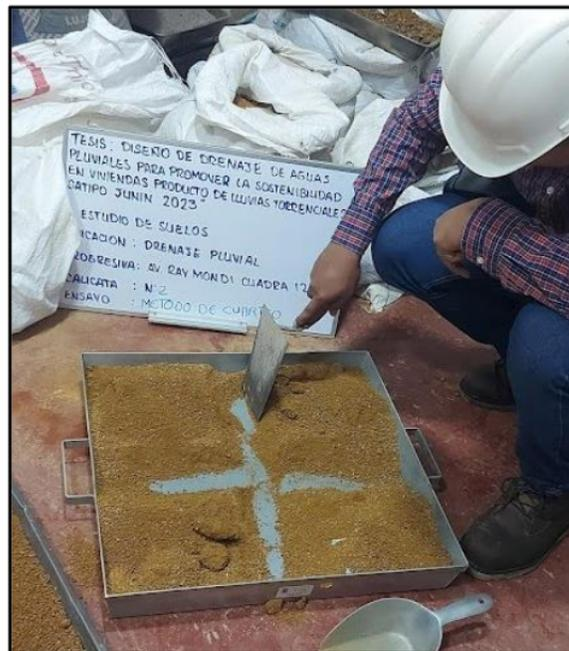
Fotografía N° 06. Se observa al tesista Angelo Alexander Castañeda Hinostroza realizando el cuarteo de la calicata N° 2. En el Laboratorio De Geodinámica E.I.R.L, el 25 de junio del 2023.
