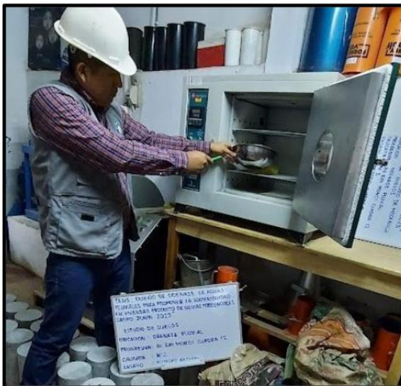
Fotografía N° 10. Se observa al tesista Angelo Alexander Castañeda Hinostroza realizando el análisis de humedad natural de la muestra de Calicata N° 02, el 25 de junio de 2023.
