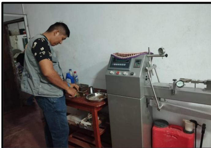
Fotografía N° 13. Se observa al tesista Angelo Alexander Castañeda Hinostraza realizando el ensayo de corte directo, con la caja de corte y las taras con muestras de la Calicata N° 01 y 02, el 26 de junio de 2023.
