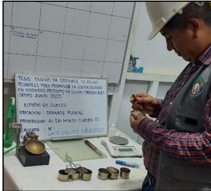
Fotografía N° 11. Se observa al tesista Angelo Alexander Castañeda Hinostrroza realizando el análisis de límites de Atterberg, con la cuchara de Casa Grande y las taras con muestras de la Calicata N° 01, el 25 de junio del 2023.
