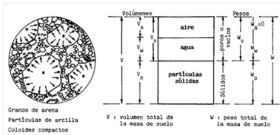
Estructura de un suelo mixto
