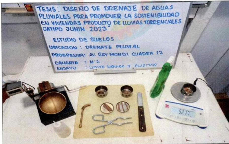
ENSAYO DE LIMITE LIQUIDO Y PLASTICO DE LA CALICATA 2 DEL DRENAJE PLUVIAL DE LA AV. RAYMONDI CUADRA 12
