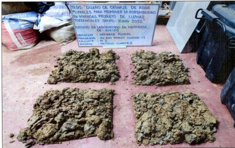
ENSAYO DE METODO DE CUARTEO DE LA CALICATA 2 DEL DRENAJE PLUVIAL DE LA AV. RAYMONDI CUADRA 12
