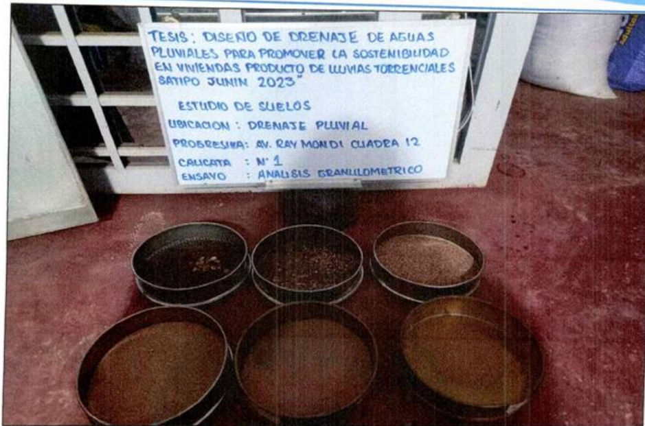
ENSAYO DE ANALISIS GRANULOMETRICO DE LA CALICATA 1 DEL DRENAJE PLUVIAL DE LA AV. RAYMONDI CUADRA 12
