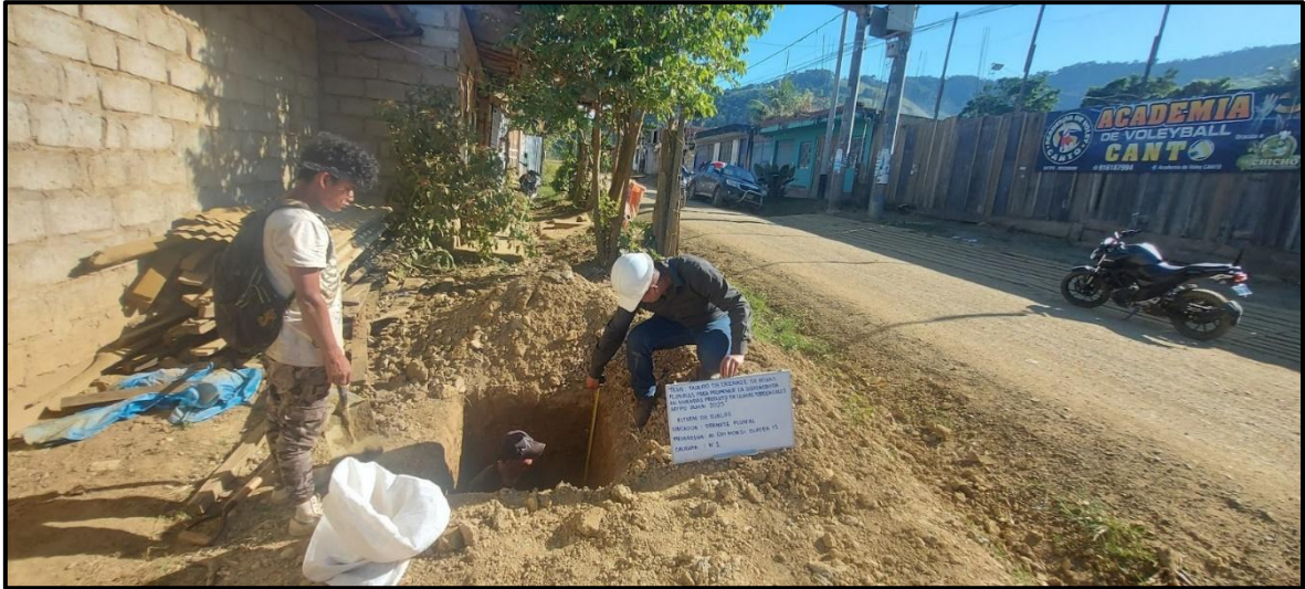
Fotografía N° 05. Se observa al tesista Angelo Alexander Castañeda Hinostroza tomando medidas de la calicata N° 01 y la muestra de 3.000 gr, el 23 de junio del 2023.
