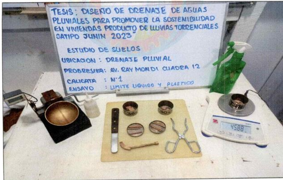
ENSAYO DE LIMITE LIQUIDO Y PLASTICO DE LA CALICATA 1 DEL DRENAJE PLUVIAL DE LA AV. RAYMONDI CUADRA 12
