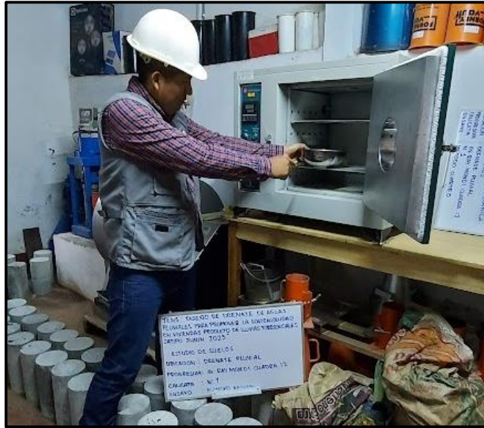
Fotografía N° 09. Se observa al tesista Angelo Alexander Castañeda Hinostroza realizando el análisis de humedad natural de la muestra de Calicata N° 01, el 25 de junio del 2023.
