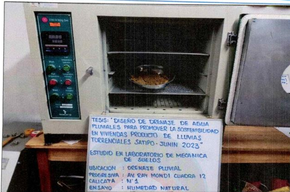
ENSAYO DE HUMEDAD NATURAL CALICATA 1 DEL DRENAJE PLUVIAL DE LA AV. RAYMONDI CUADRA 12
