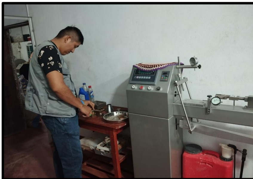
Fotografía N° 13. Se observa al tesista Angelo Alexander Castañeda Hinostrza realizando el ensayo de corte directo, con la caja de corte y las taras con muestras de la Calicata N° 01 y 02, el 26 de junio de 2023.
