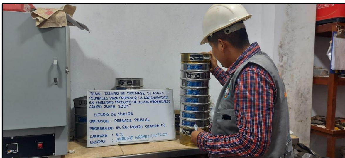
Fotografía N° 08. Se observa al tesista Angelo Alexander Castañeda Hinostroza realizando el análisis granulométrico con la muestra de la calicata N° 02, el 25 de junio de 2023.
