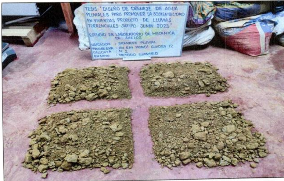
ENSAYO DE METODO DE CUARTEO DE LA CALICATA 1 DEL DRENAJE PLUVIAL DE LA AV. RAYMONDI CUADRA 12
