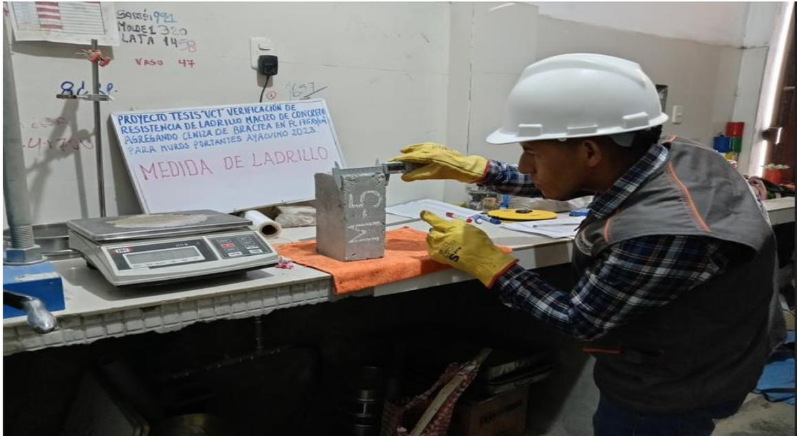
*Nota:* Realizando la medida de ladrillo macizo de concreto para obtener el resultado si es cóncava o convexa en laboratorio de concreto JKEMSCA S.A.C.
