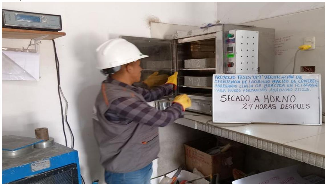
*Nota:* Sacando el ladrillo macizo después de 24 horas secado en el horno.
