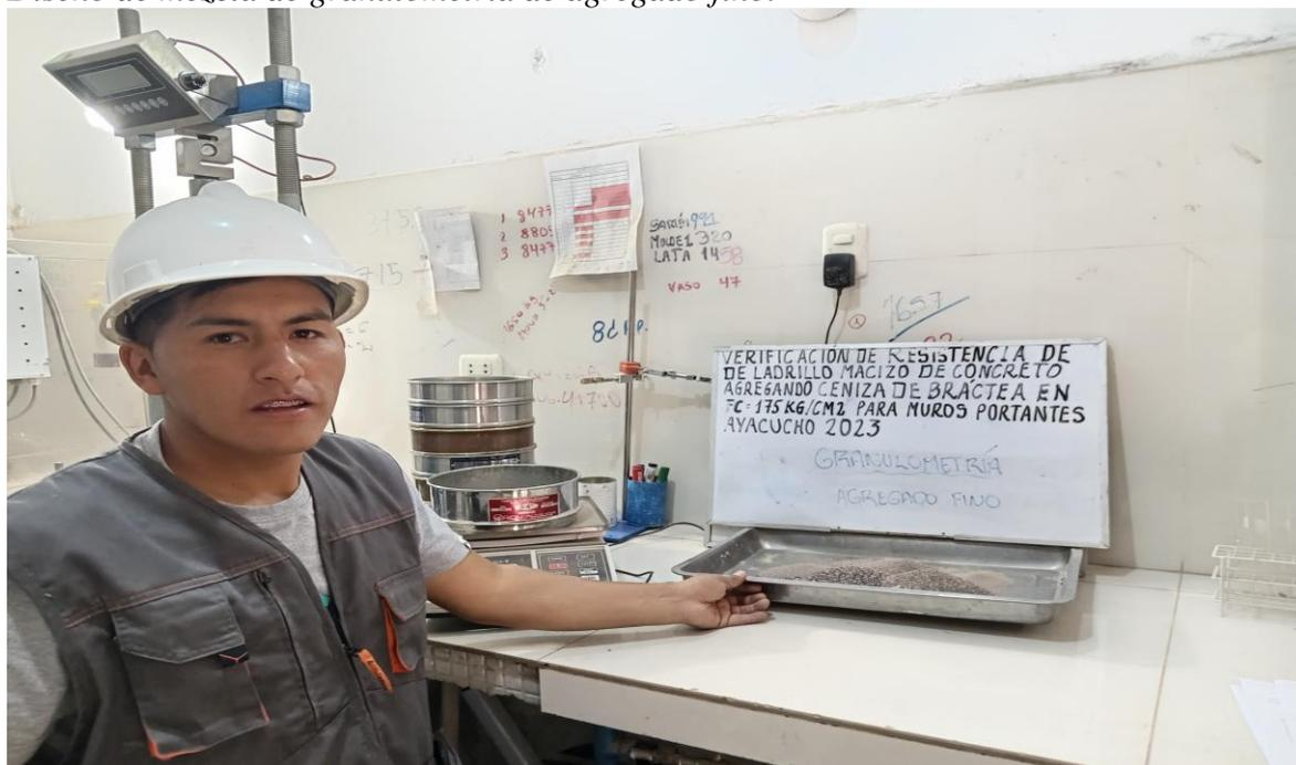
*Nota:* Elaborando la clasificación de la granulometría de agregado fino en laboratorio de concreto JKEMSCA S.A.C.
