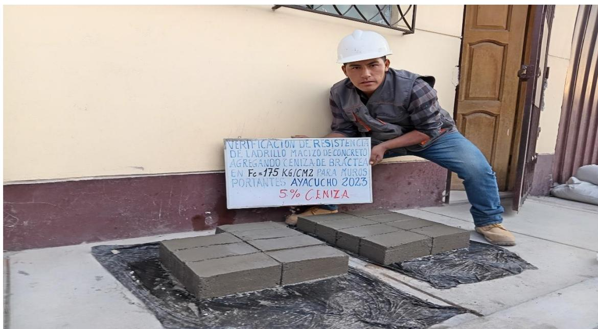
*Nota:* Preparando la mezcla para la elaboración de ladrillo macizo de concreto agregando 5% de ceniza de bráctea.
