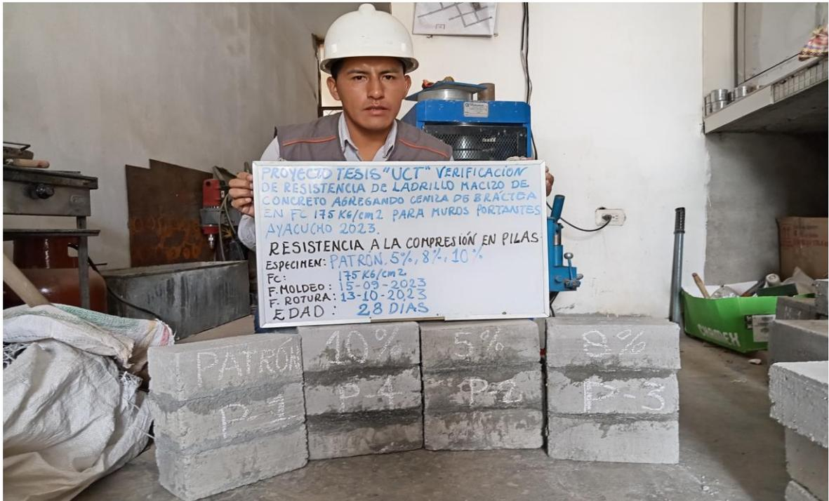
*Nota: Muestra de ladrillos a pilas antes de realizar la resistencia a la compresión.*
