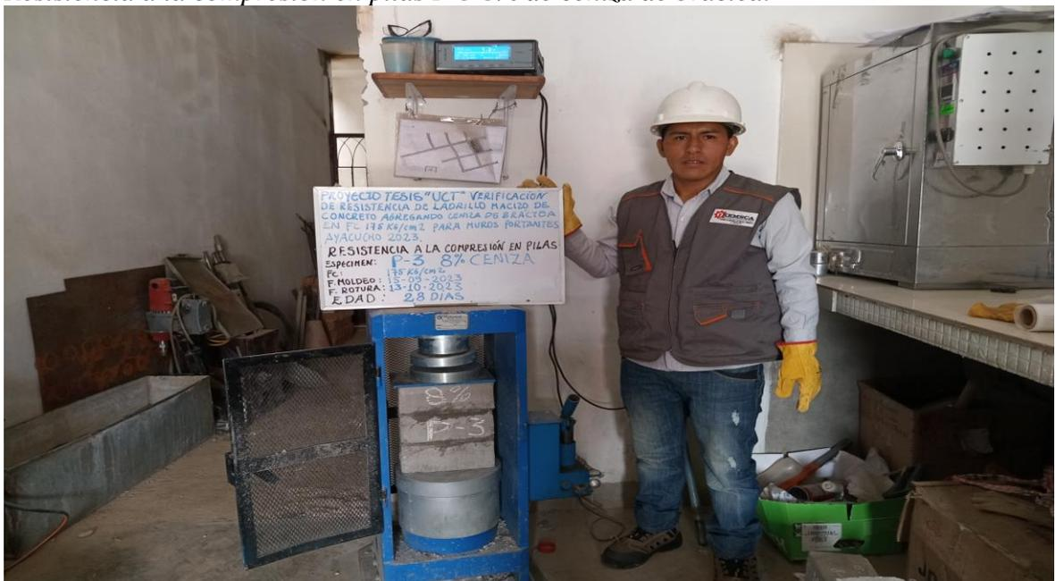
*Nota: Resistencia a compresión en pilas de ladrillo macizo incorporando 8% de ceniza.*
