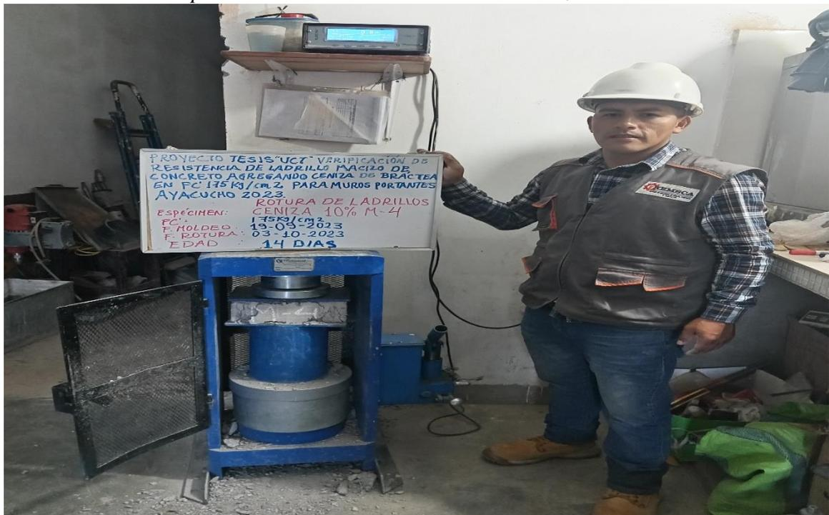
*Nota: Después de realizar la rotura a compresión de ladrillo de M-4.*
