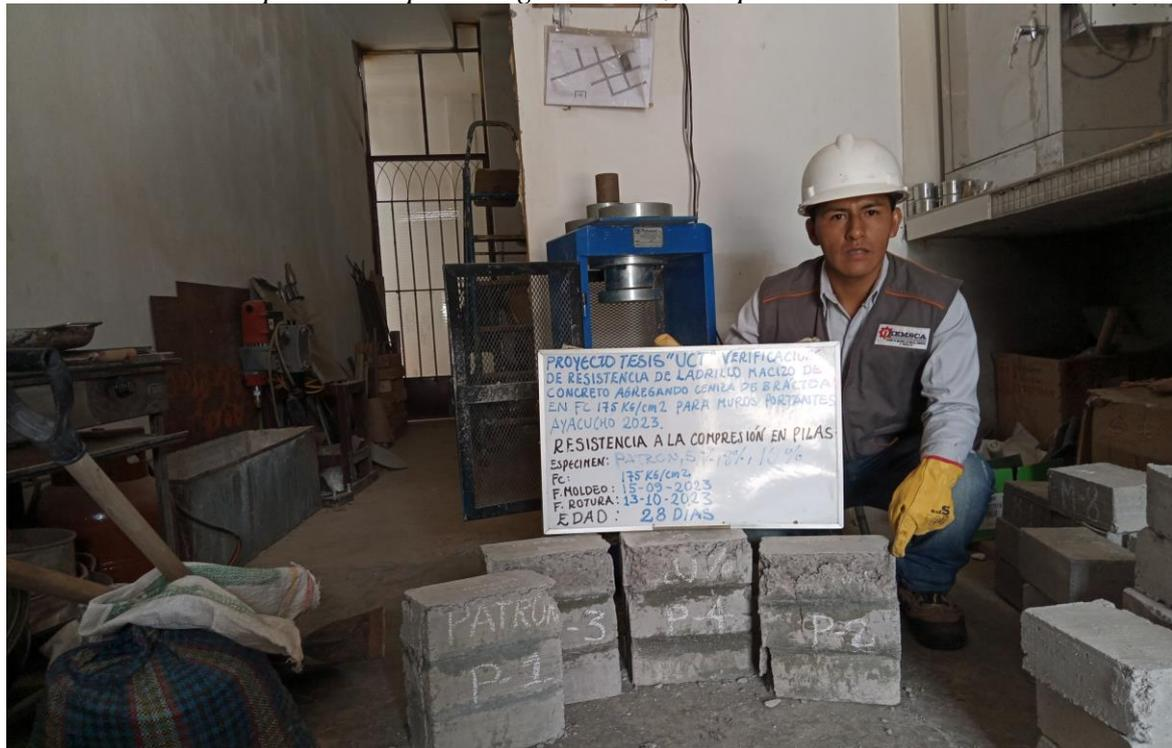
*Nota:* Se evidencia la muestra de ladrillos después de compresión en pilas.
