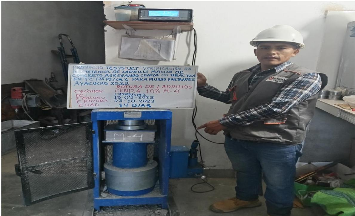
*Nota: Antes de realizar la rotura a compresión de ladrillo M-4.*
