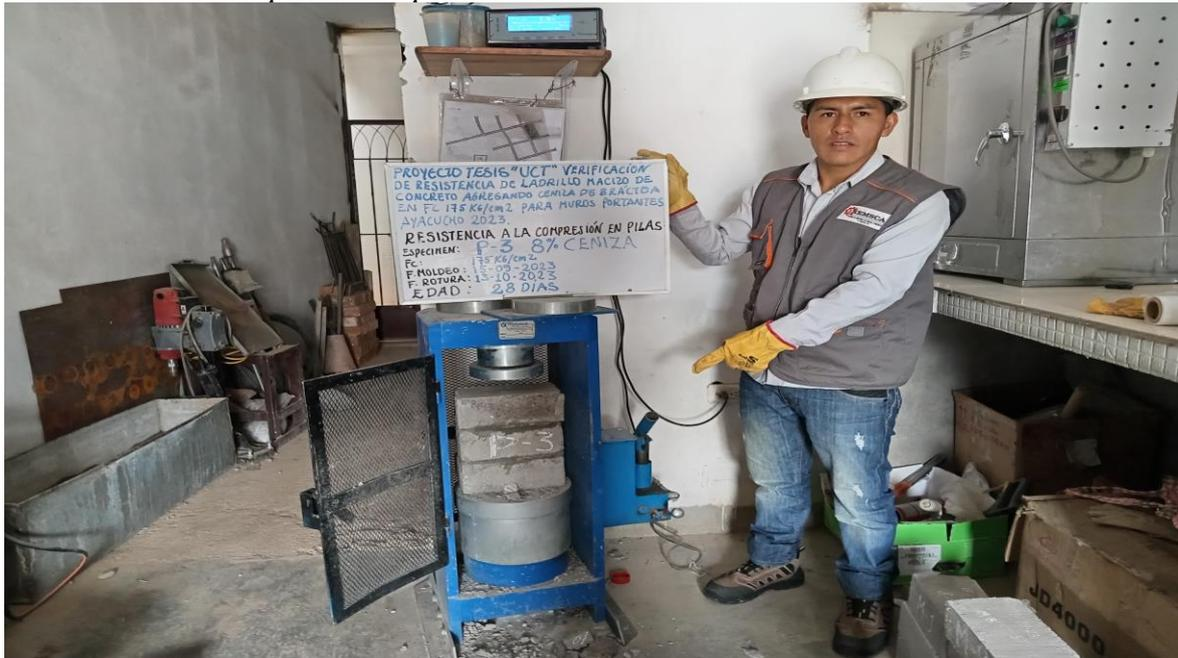
*Nota:* Resultado de realizar resistencia a compresión en pilas de ladrillo macizo incorporando 8% de ceniza.
