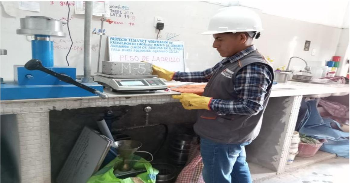
*Nota:* Realizando el peso de ladrillo macizo de concreto en laboratorio de concreto JKEMSCA S.A.C.
