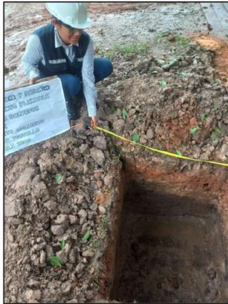
Fotografía N° 04. Obtención de la muestra de suelo en la excavación N° 02.
