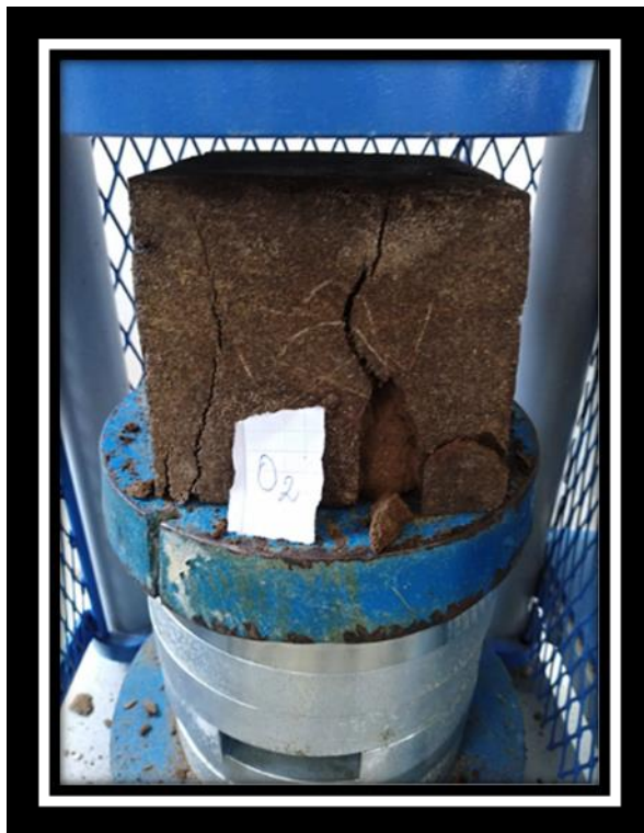
ILUSTRACIÓN 13. ADOBE FRACTURADO. RES. 602 Kgf - 25 % DE MELAZA.
