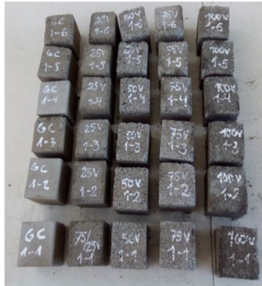
Figura N°05: Probetas con agregados reciclados vidrio
