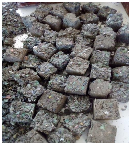
Figura N°06: Probetas con agregados reciclado plástico
