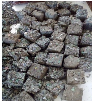
Figura N°06: Probetas con agregados reciclado plástico
