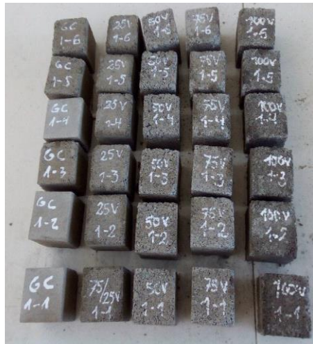
Figura N°05: Probetas con agregados reciclados vidrio
