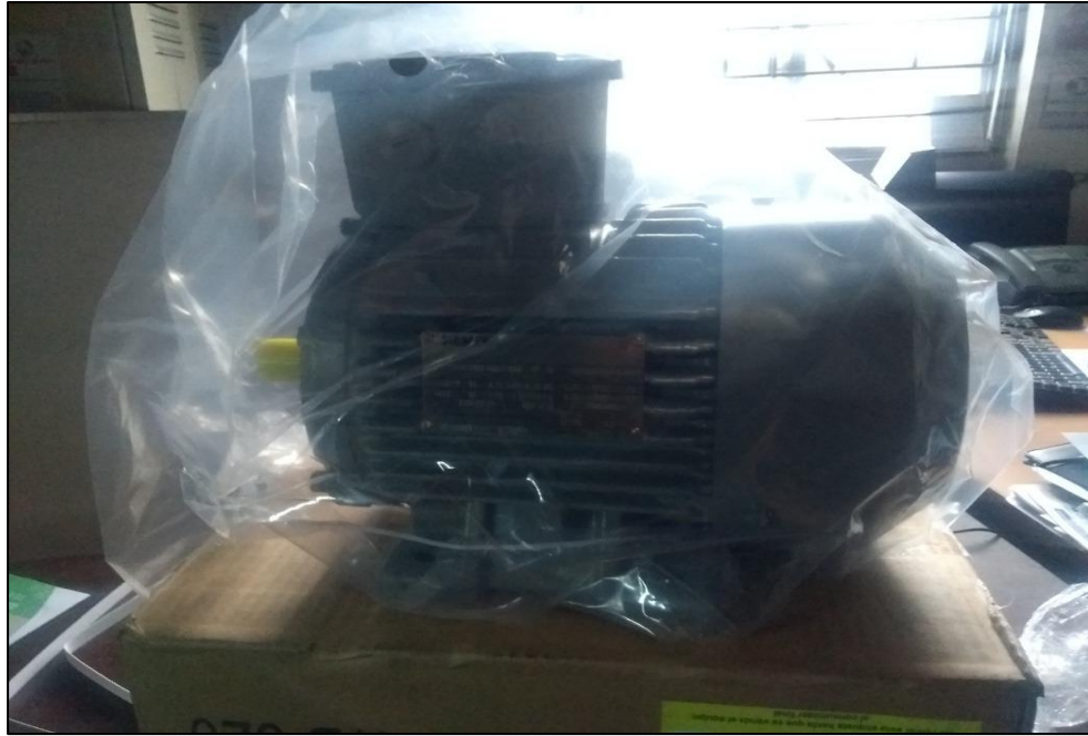
Figura 20: Módulo del motor trifásico
