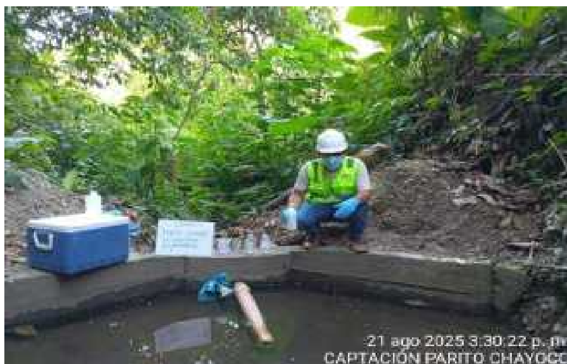
Figura 15. Extracion de muestras de agua en la captación Parito Chayocc
