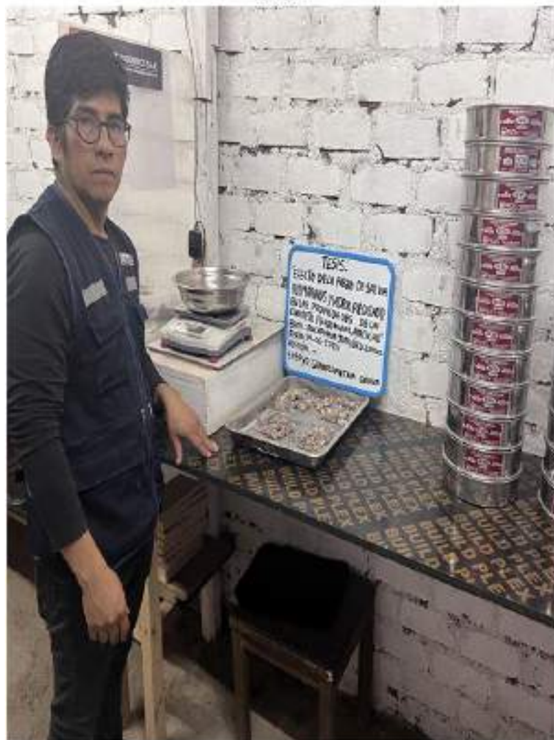
Foto N°07: Análisis granulométrico del agregado fino
