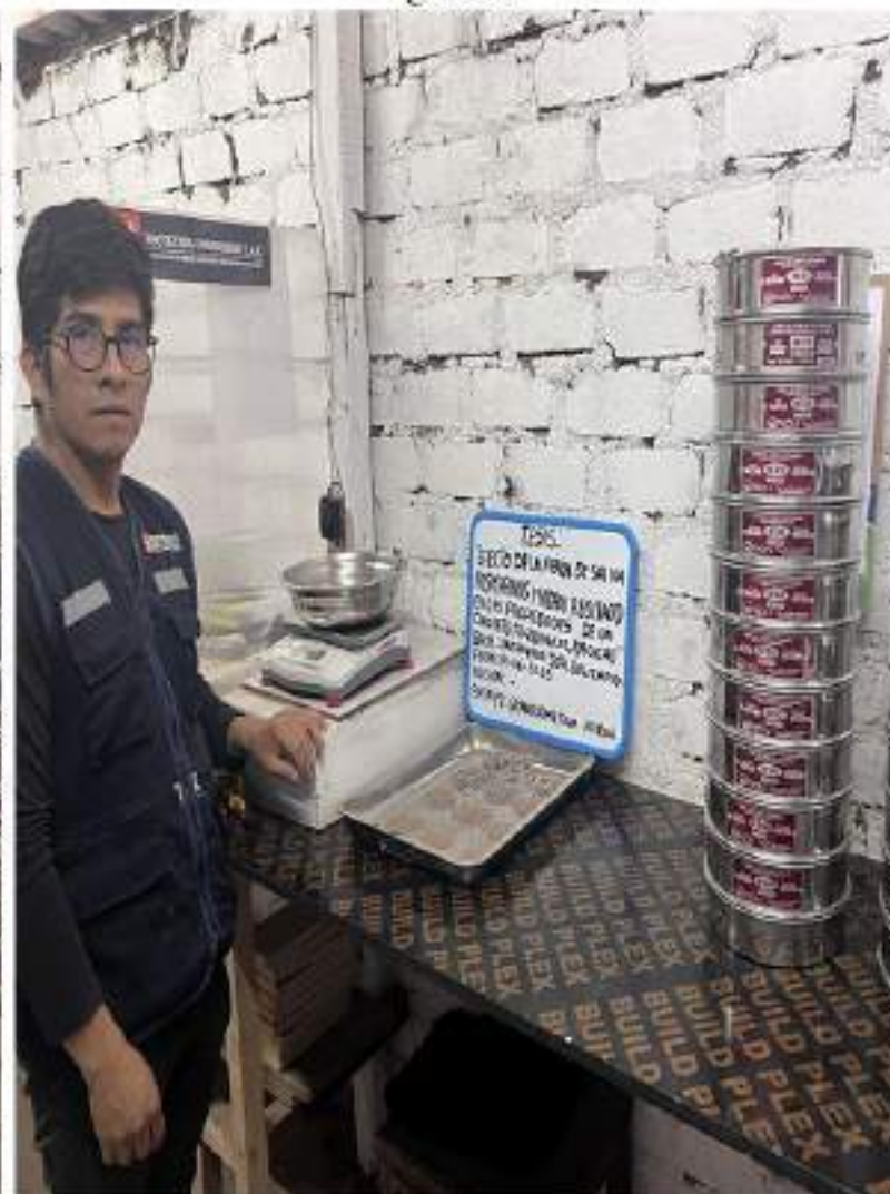
Foto N°08: Análisis granulométrico del agregado grueso
