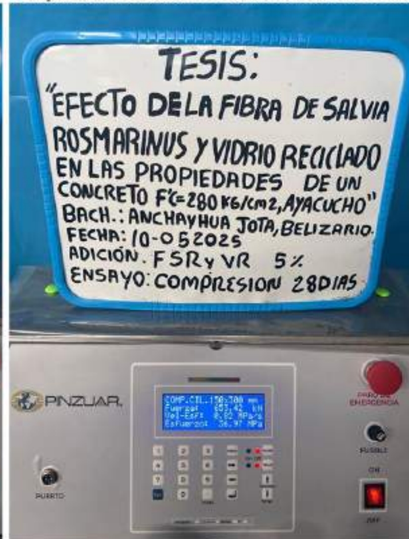
Foto N°20: Lectura digital de la resistencia a la compresión a una edad de 28 días con adición al 5%
