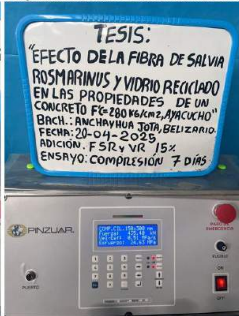
Foto N°16: Lectura digital de la resistencia a la compresión a una edad de 7 días con adición al 15%
