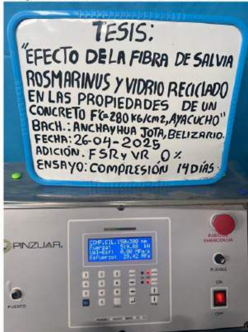
Foto N°17: Lectura digital de la resistencia a la compresión a una edad de 14 días con adición al 0%
