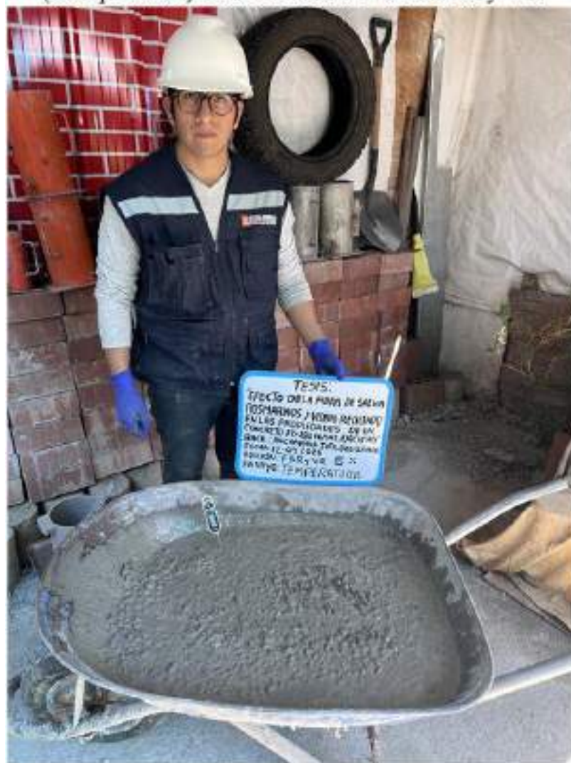
Foto N°11: Ensayos en concreto fresco (Temperatura) con adición al 5% de FSR y VR
