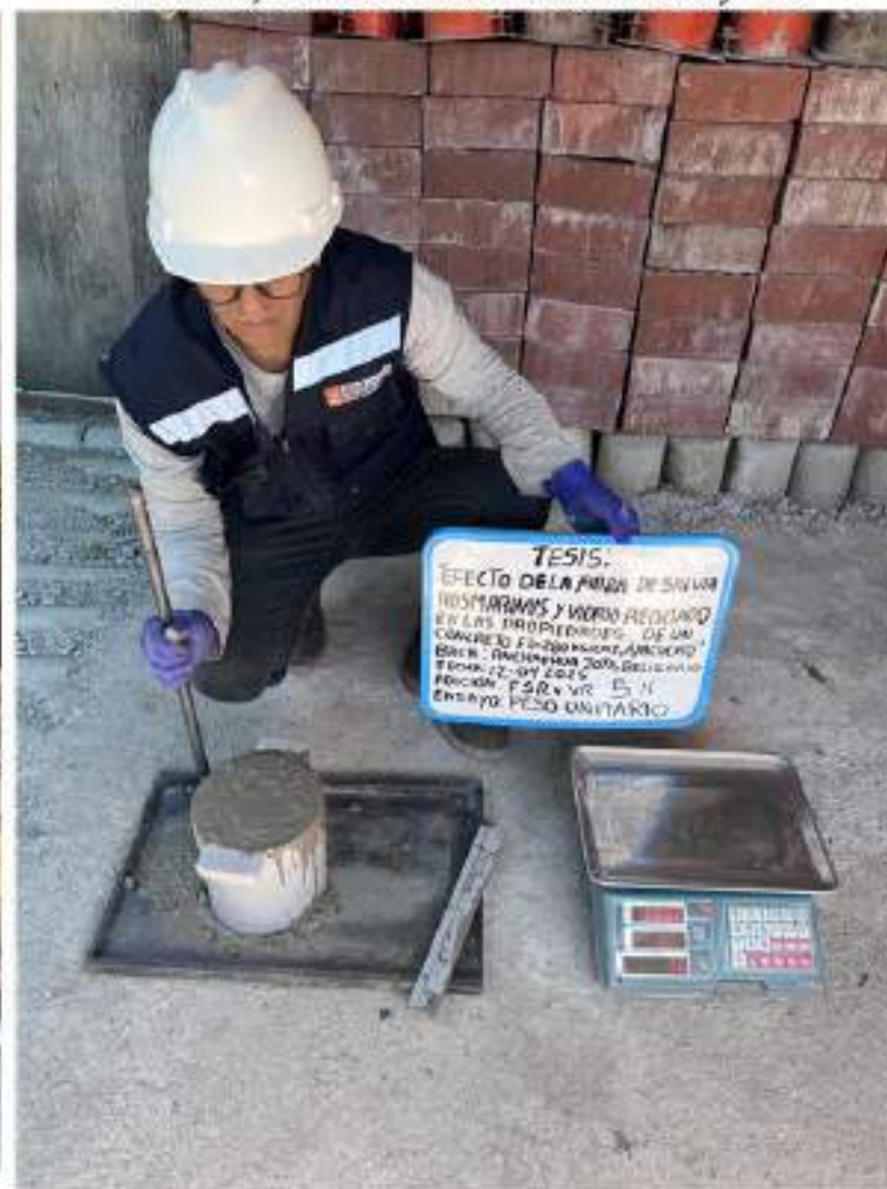
Foto N°12: Ensayos en concreto fresco (Peso Unitario) con adición al 5% de FSR y VR
