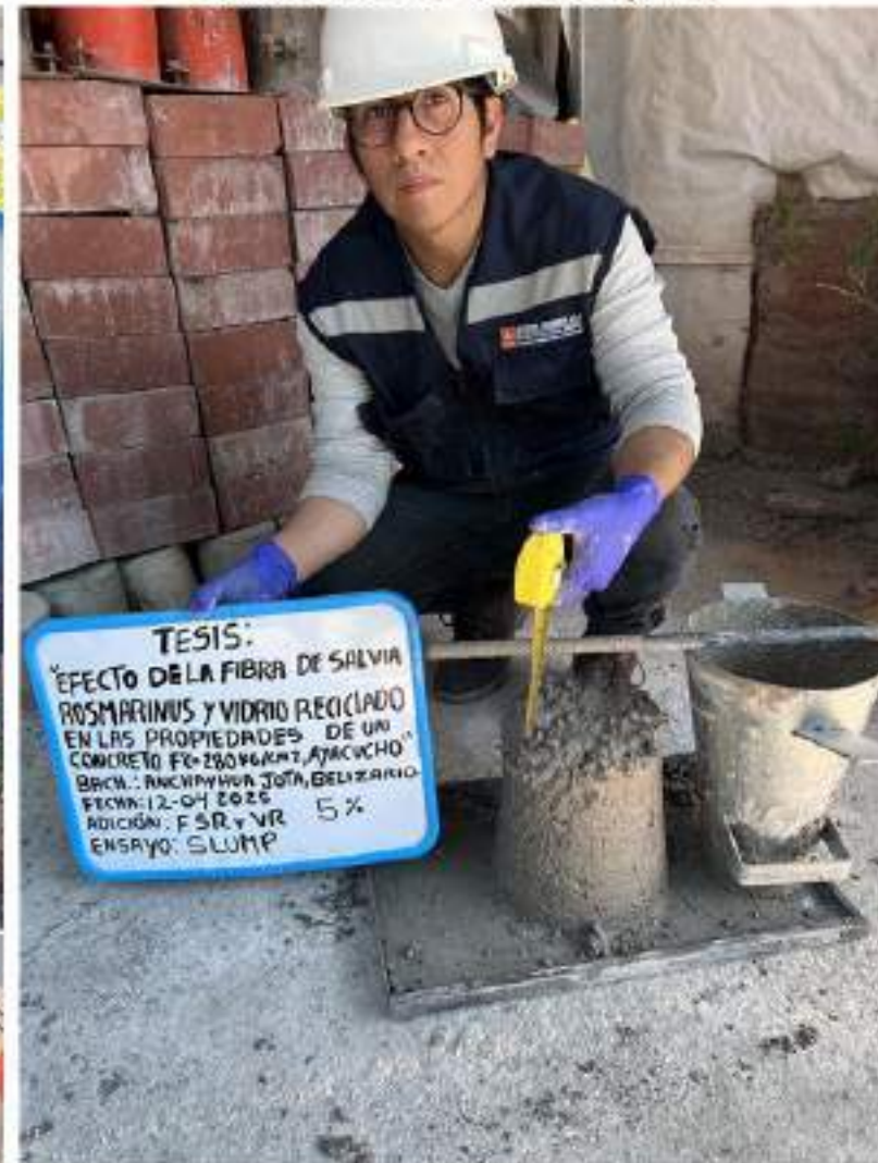
Foto N°10: Ensayos en concreto fresco (SLUMP) con adición al 5% de FSR y VR
