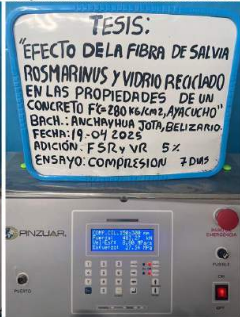
Foto N°14: Lectura digital de la resistencia a la compresión a una edad de 7 días con adición al 5%
