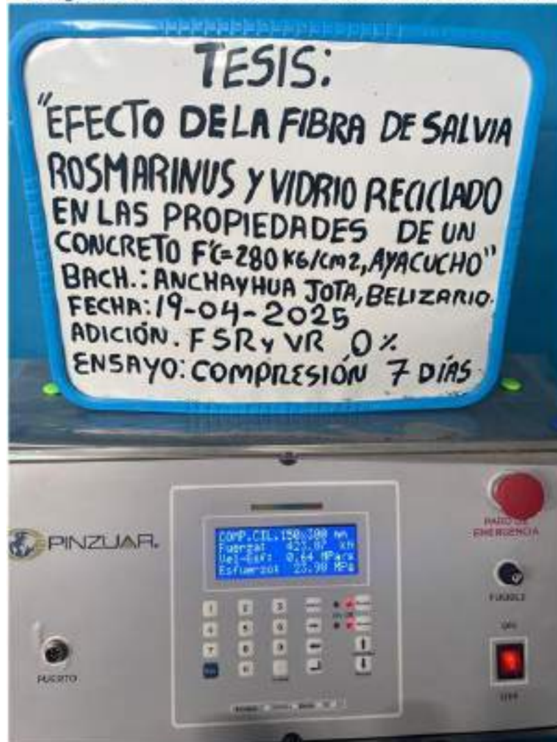
Foto N°13: Lectura digital de la resistencia a la compresión a una edad de 7 días con adición al 0%
