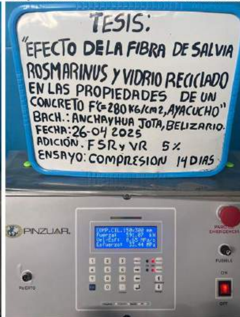
Foto N°18: Lectura digital de la resistencia a la compresión a una edad de 14 días con adición al 5%
