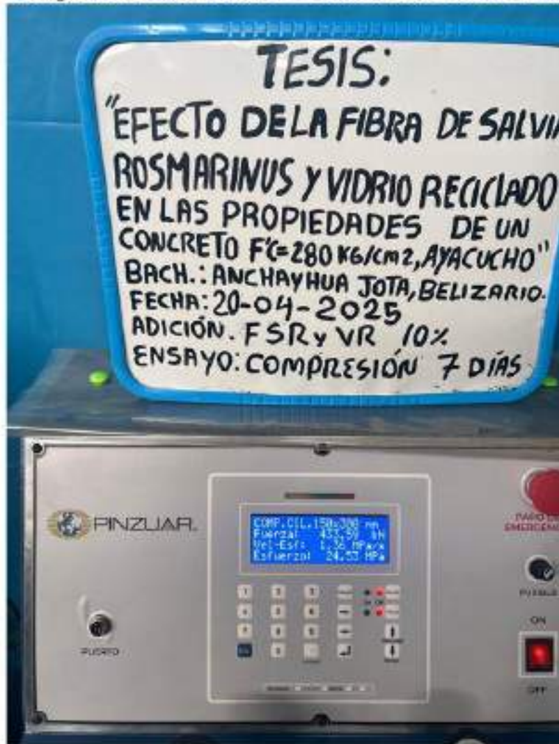
Foto N°15: Lectura digital de la resistencia a la compresión a una edad de 7 días con adición al 10%
