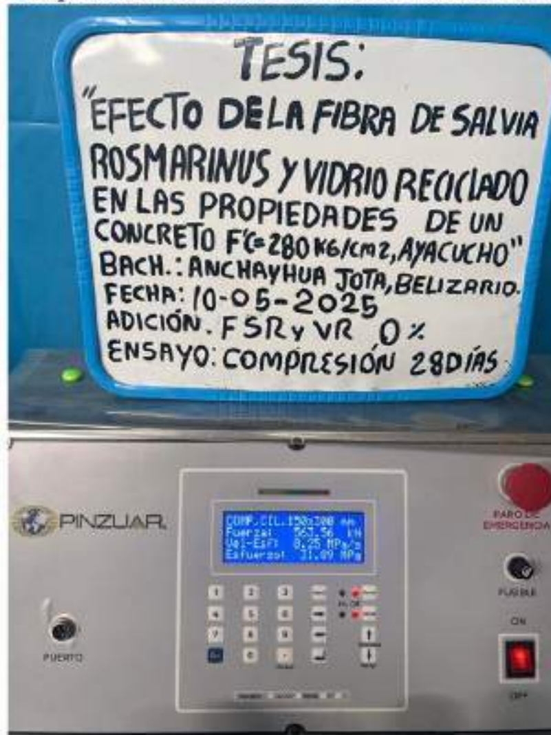
Foto N°19: Lectura digital de la resistencia a la compresión a una edad de 28 días con adición al 0%
