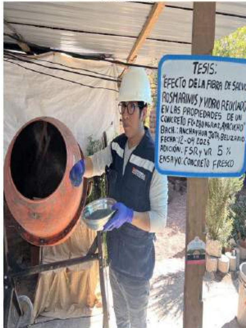
Foto N°09: Adición al 5% de FSR y VR a la mezcla de concreto
