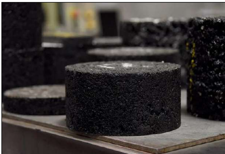
Mezcla asfáltica en caliente
