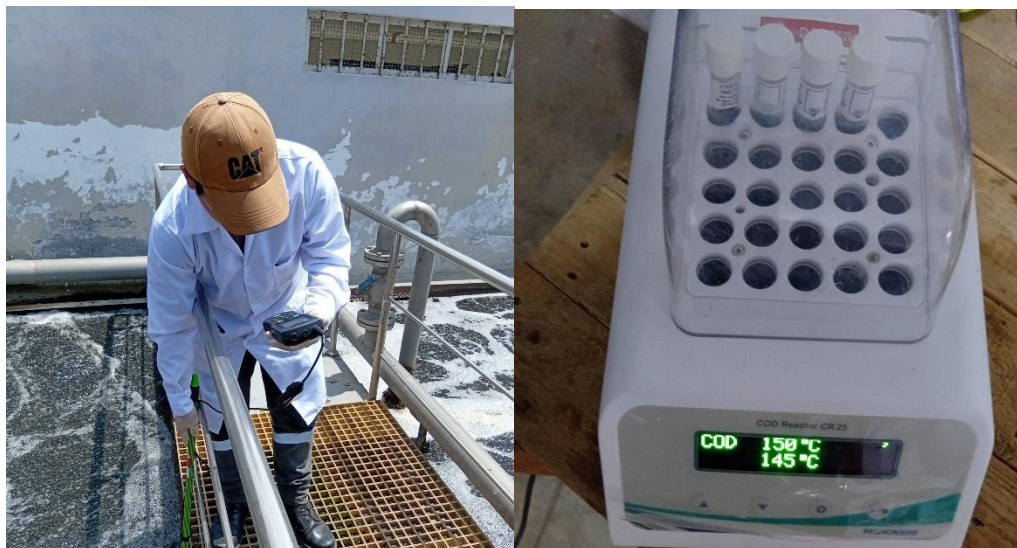
Figura 17. Recolección de muestras (izquierda), COD Reactor CR25 (derecha)
