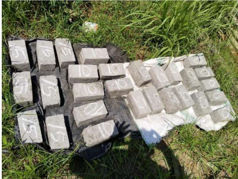
Fotografía 9. Secado de las 36 muestras de adoquín con cenizas de Ishpingo, elaborados por el Bachiller Dick Rolling Castillo Vasquez.
