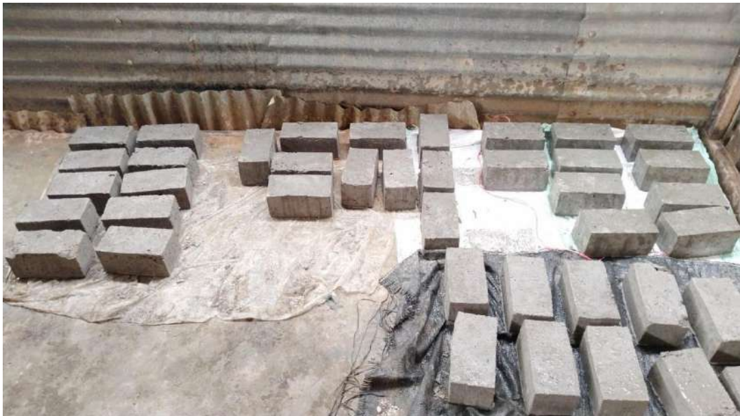
Fotografía 8. Curado de las 36 muestras de adoquín con cenizas de Ishpingo, elaborados por el Bachiller Dick Rolling Castillo Vasquez.
