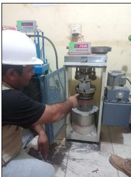
Fotografía 14. Rotura de 12 probetas con 0%, 5%, 10% y 15% de cenizas de Ishpingo, a romper a los 14 días, por el Bachiller Dick Rolling Castillo Vasquez.
