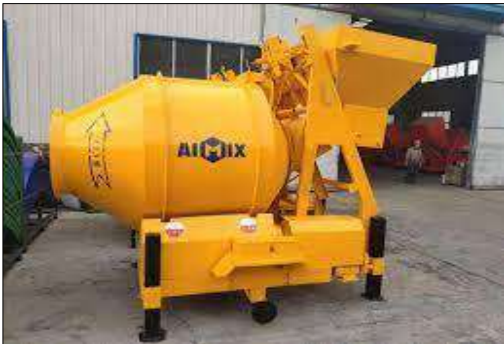
Mezcladora de concreto
