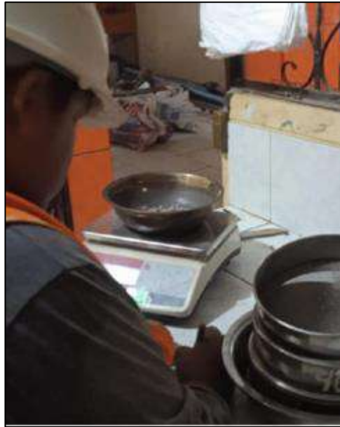
Fotografía 3. Ensayo granulométrico de agregados elaborado por el Bachiller Dick Rolling Castillo Vasquez.
