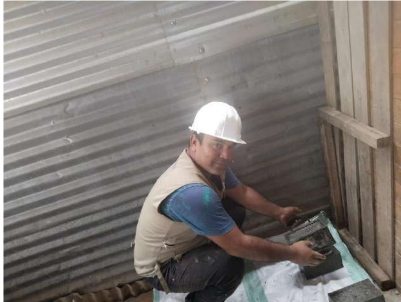
Fotografía 7. Moldeado de adoquines de concreto con cenizas de Ishpingo al 0%, 5%, 10% y 15% por el Bachiller Dick Rolling Castillo Vasquez.
