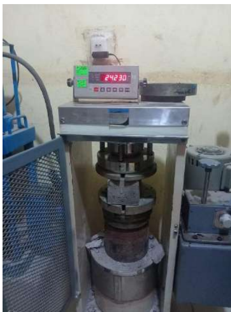
Fotografía 13. Rotura de 12 probetas con 0%, 5%, 10% y 15% de cenizas de Ishpingo, a romper a los 14 días, por el Bachiller Dick Rolling Castillo Vasquez.
