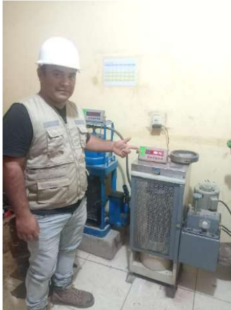
Fotografía 11. Rotura de 12 probetas con 0%, 5%, 10% y 15% de cenizas de Ishpingo, a romper a los 14 días, por el Bachiller Dick Rolling Castillo Vasquez.
