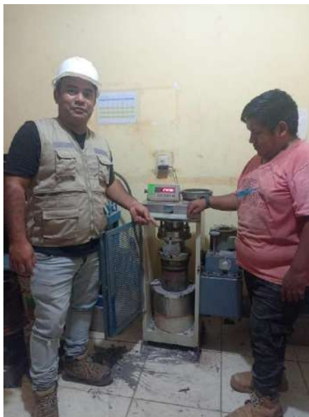
Fotografía 12. Rotura de 12 probetas con 0%, 5%, 10% y 15% de cenizas de Ishpingo, a romper a los 14 días, por el Bachiller Dick Rolling Castillo Vasquez.
