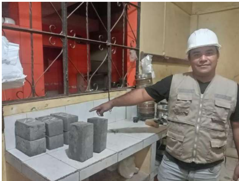
Fotografía 10. Selección de 12 probetas con 0%, 5%, 10% y 15% de cenizas de Ishpingo, a romper a los 7 días, por el Bachiller Dick Rolling Castillo Vasquez.
