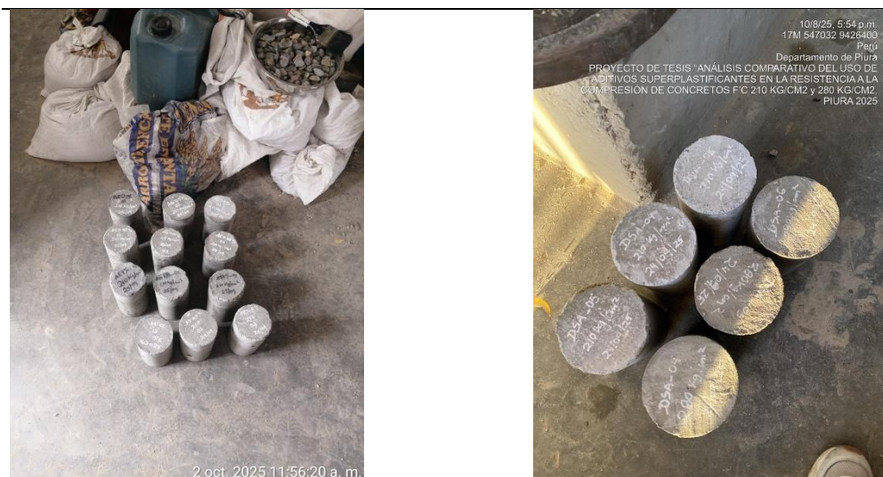
Figura N° 10: Desencofrado de probetas.
