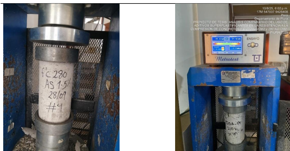
Figura N° 12: Ensayo para determinar la resistencia a la compresión del concreto (NTP.339.034, 2015)
