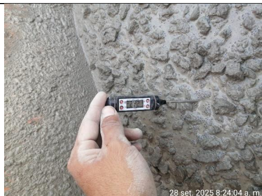
Figura N° 7: Ensayo para la determinación de temperatura (NTP 339.184, 2021)
