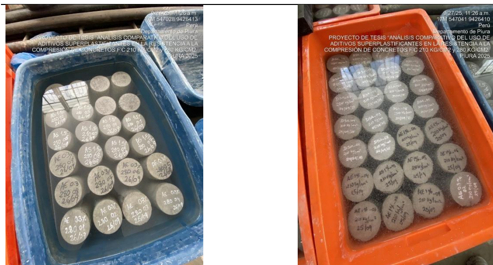
Figura N° 11: Curado de probetas de concreto
