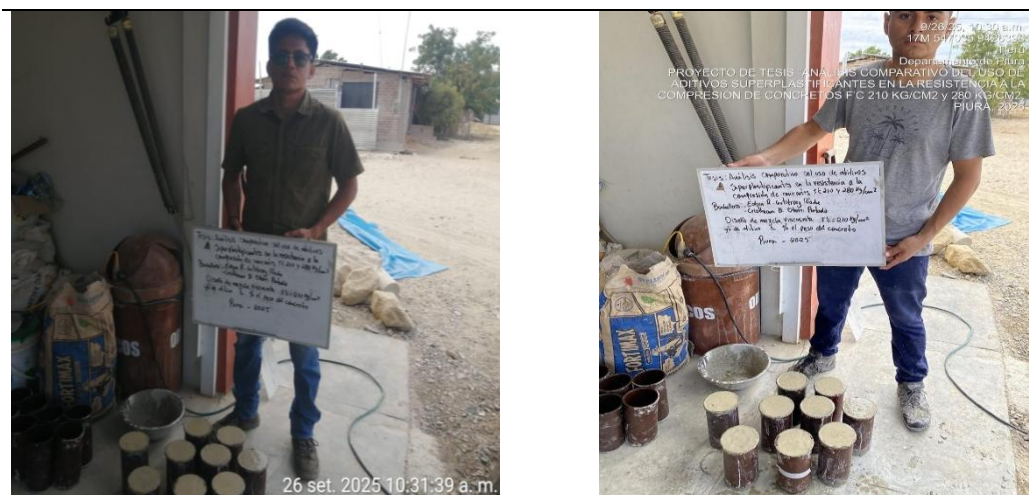
Figura N° 9: Elaboración de probetas de concreto
