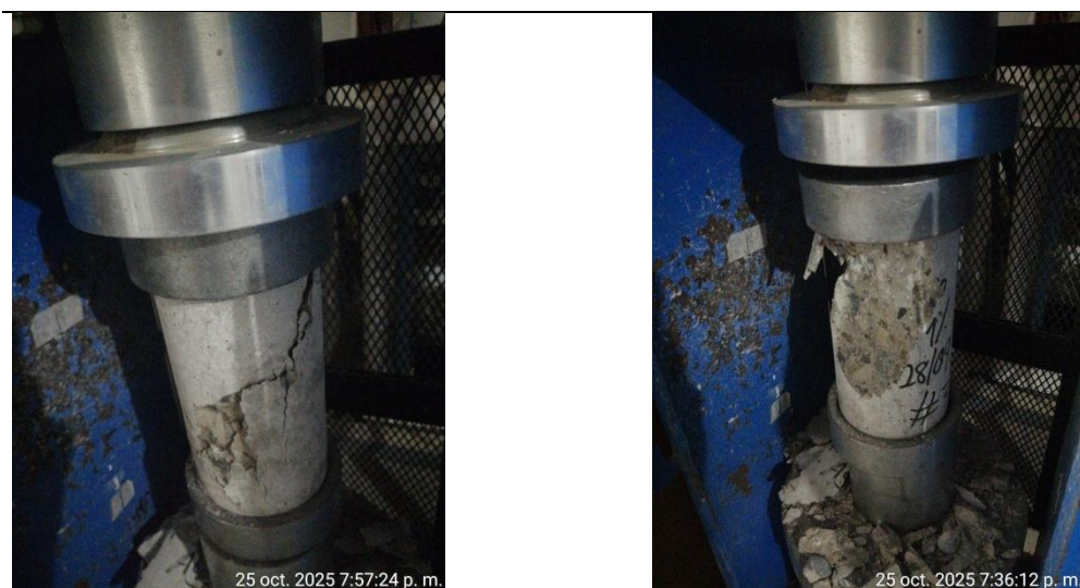
Figura N° 13: Fallo de probetas de concreto.
