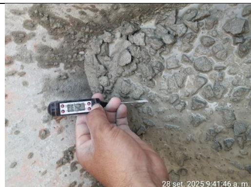
Figura N° 7: Ensayo para la determinación de temperatura (NTP 339.184, 2021)
