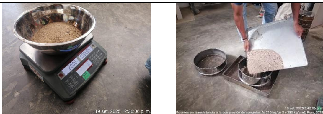
Figura N° 3: Ensayo para determinar la Granulometría del agregado fino y grueso (NTP.400.012)
