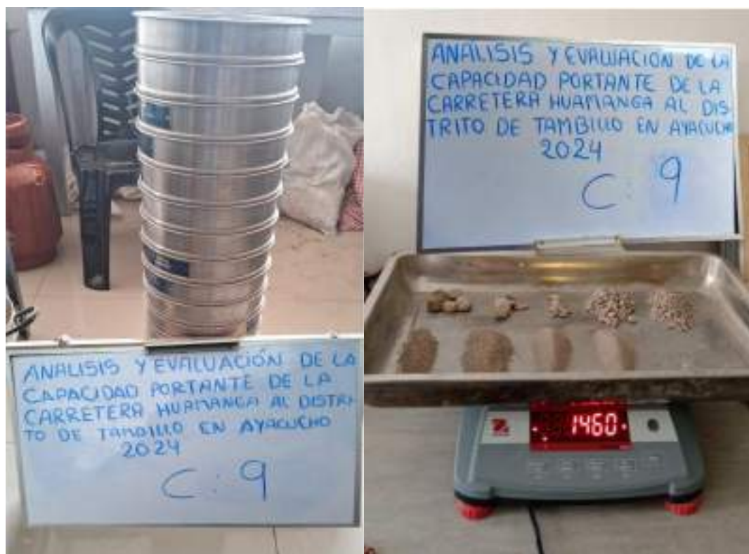
MUESTRA 9: pasando el tamizare y obteniendo la granulometría
