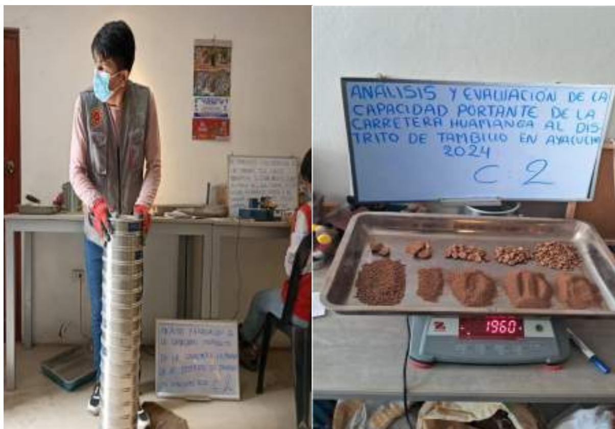
MUESTRA 2: pasando el tamizare y obteniendo la granulometría
