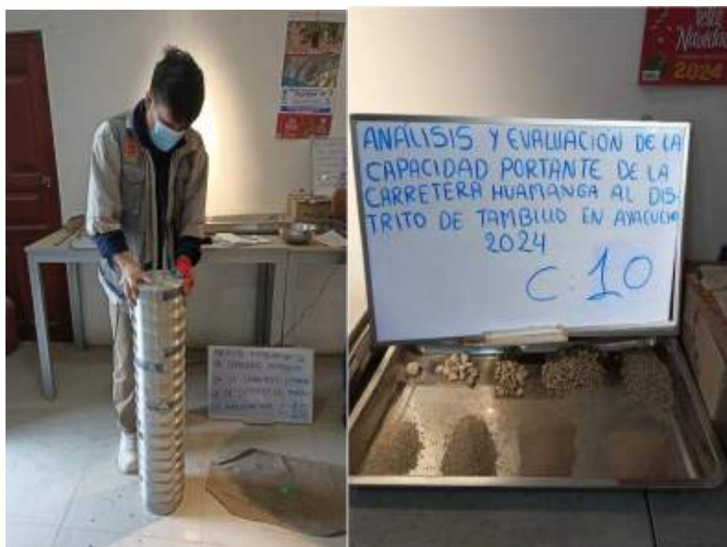
MUESTRA 10: pasando el tamizare y obteniendo la granulometría
