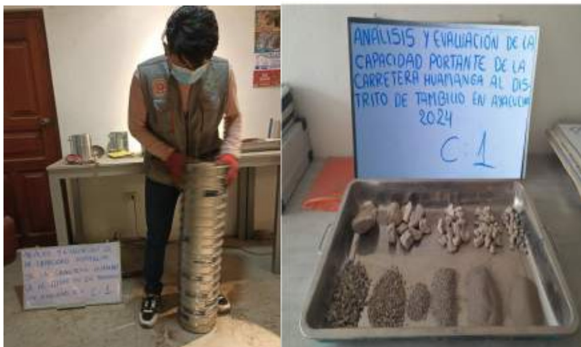
MUESTRA 1: pasando el tamizare y obteniendo la granulometría
