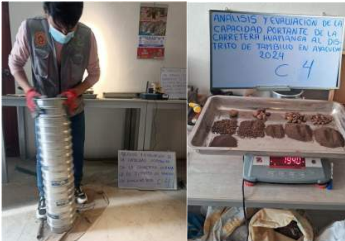
MUESTRA 4: pasando el tamizare y obteniendo la granulometría.
