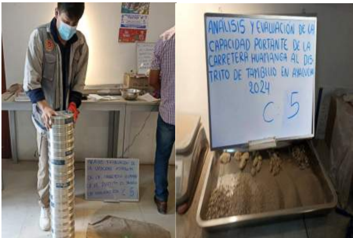
MUESTRA 5: pasando el tamizare y obteniendo la granulometría
